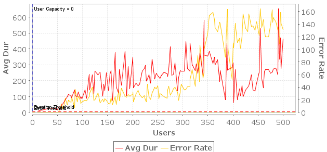
Abbildung 14: Lasttest Linux Server – Benutzerkapazitäten
